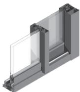
Luméal55, la baie coulissante en aluminium à ouvrant caché. Sa ligne minimaliste assure un gain de 8 à 14 % de clair de vitrage suivant son type de pose. La masse d'aluminium est réduite (-35 %) avec seulement 68 mm et 77 mm d'aluminium visible pour des performances thermiques élevées : jusqu'à  $U_w = 1.2W/m^2.K$ ,  $S_w = 0.46$  et  $TL_w = 0.65$ .
