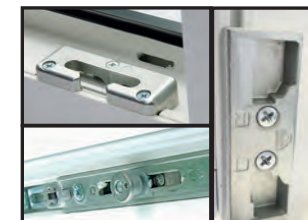
Système sécurité : rouleau champignon anti-dégondage et anti-effraction
